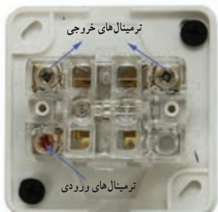
شکل ۱۴-۵- مدار داخلی کلید دو پل
