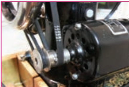
الف- ساز و کار حرکتی تسمه و چرخ تسمه در ماشین دوخت
