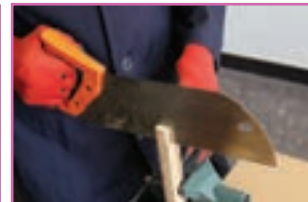
ث - اره کاری شیار بازوی چوبی
