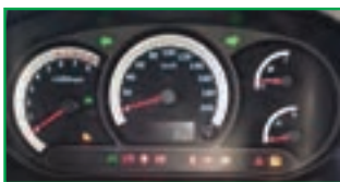
شکل ۸-۱۴- چراغ‌های هشداردهنده خودرو
