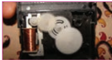
ب- بعد از باز کردن موتور ساعت
