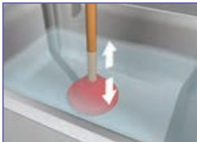
ب – حرکت عمودی لوله بازکن
