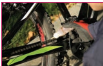
پ- روغن کاری اجزاء
