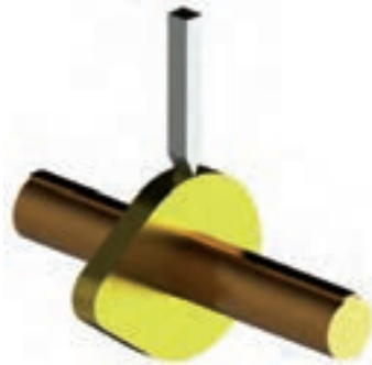
ث- ساز و کار حرکتی بادامک
