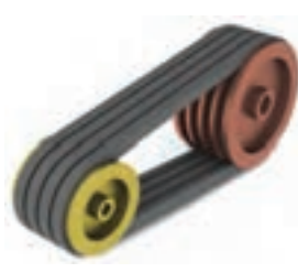
ب- ساز و کار حرکتی چرخ تسمه
